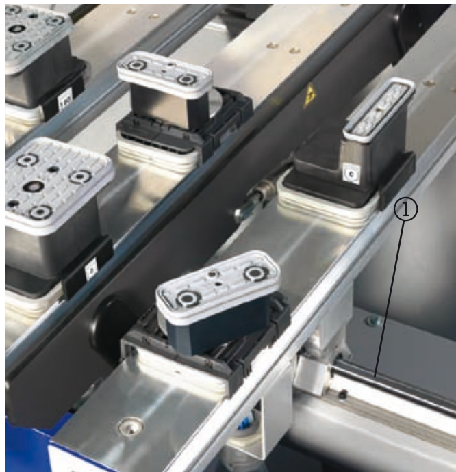
Рис. 31. Очистка цилиндрических направляющих
