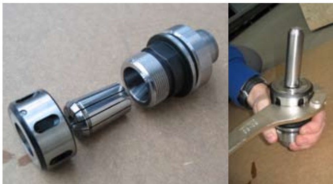
Рис. 19: Монтаж инструмента с помощью цанговых зажимов
