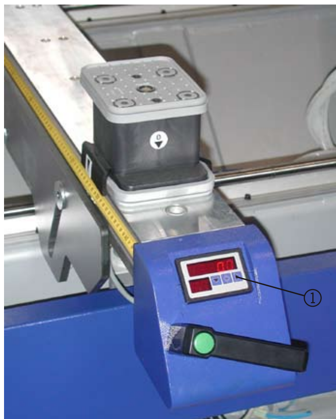
Рис. 29: Расположение присосок и консолей с цифровой индикацией
