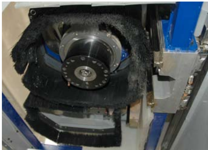
Рис. 33. Очистка и проверка исправности электрошпинделя
