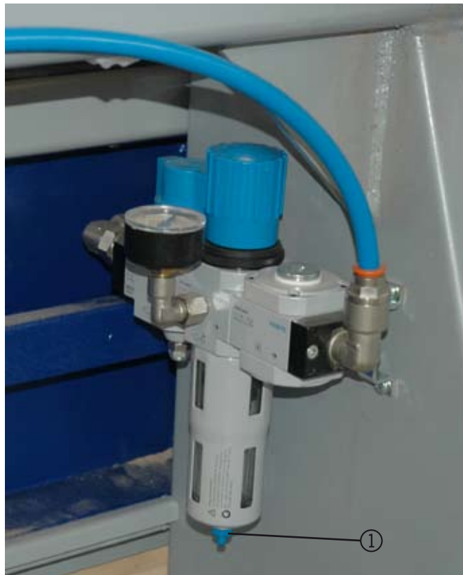
Рис. 38. Очистка регулятора воздушного фильтра
