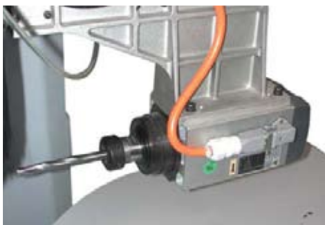
Рис. 21: Закрепление инструментов на горизонтальном фрезерном моторе
